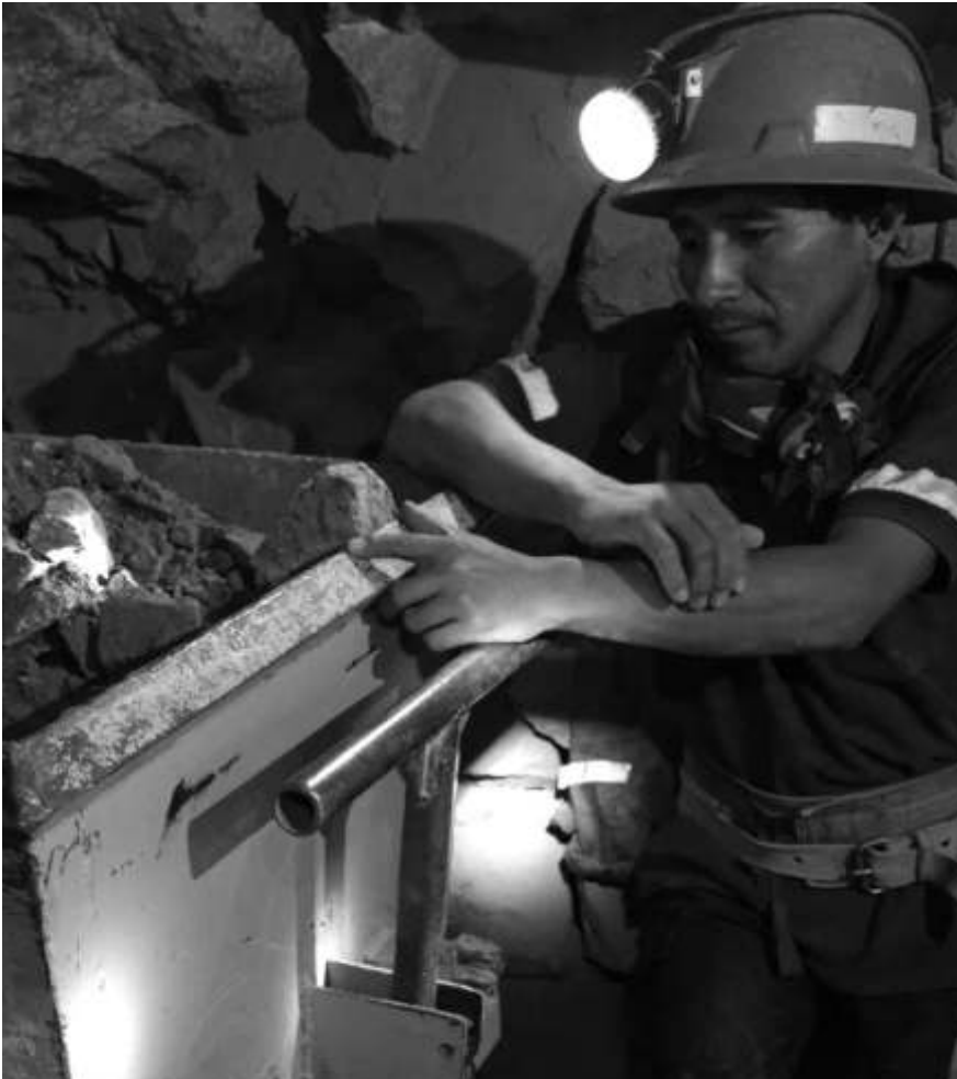
Auf der dritten Sohle tief im Berg ist es eng und die Luft ist schlecht. Das Geröll wird mit Loren auf Schienen aus dem Berg geschafft.
